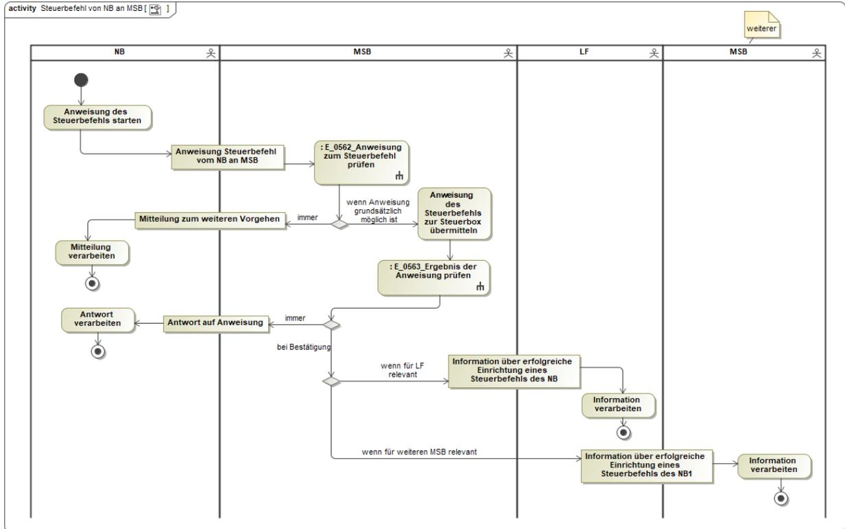
In dem AD „Steuerbefehl vom NB an MSB“ vorhandene Entscheidungsbaumdiagramme:
