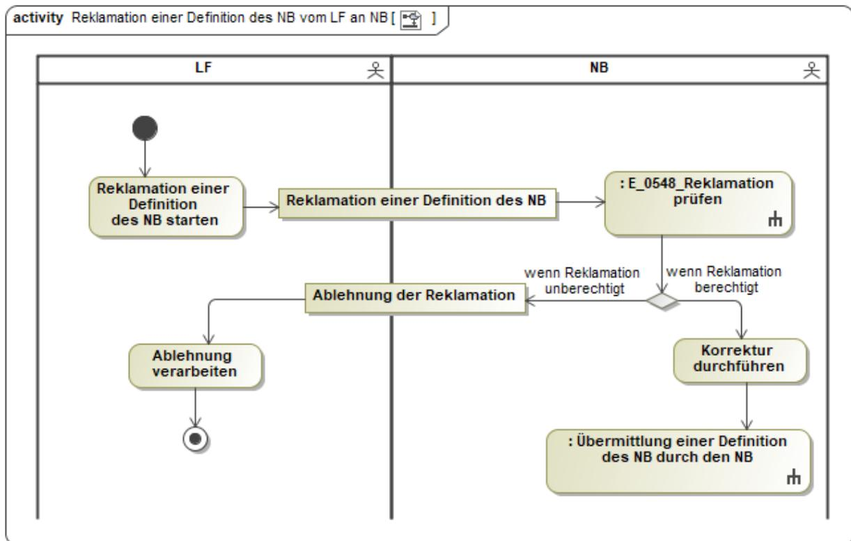
In dem AD „Reklamation einer Definition des NB vom LF an NB“ vorhandenes Entscheidungsbaumdiagramm:
